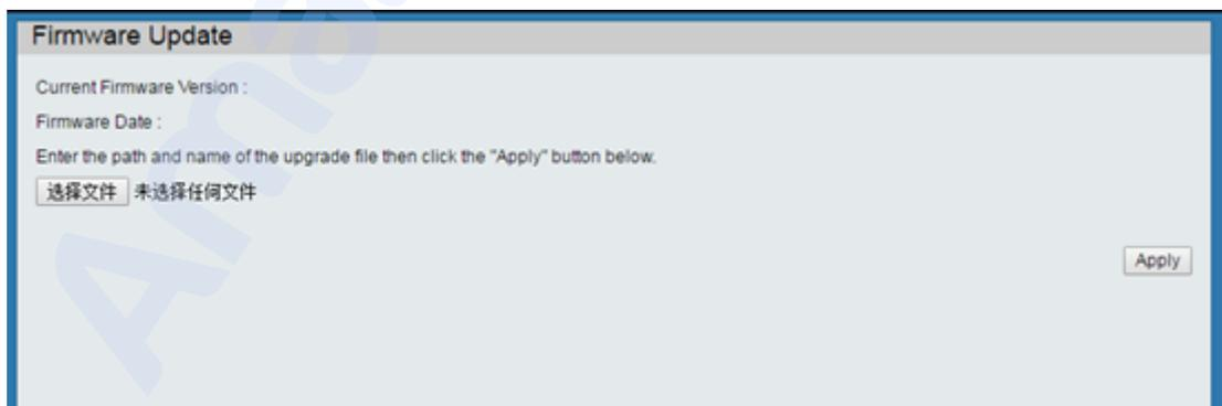
**Примечание:** Не выключайте питание коммутатора во время процесса обновления прошивки. Сбой питания во время обновления ПО может привести к необратимой поломке устройства.
